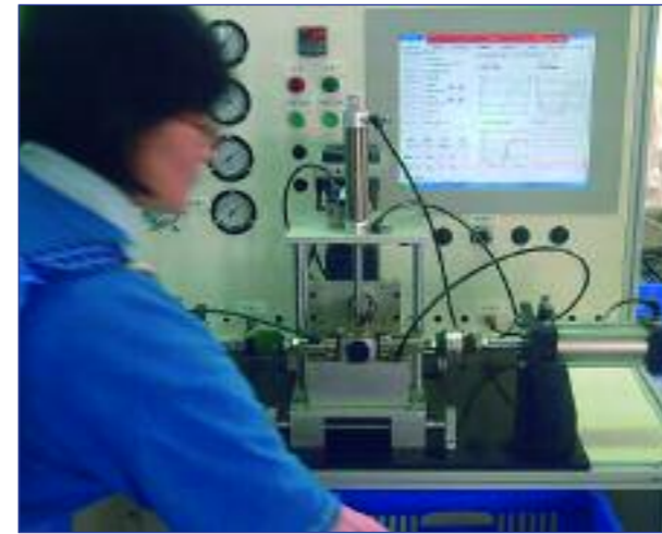
Prueba de estanquidad en cilindros en la fábrica Mindman.
